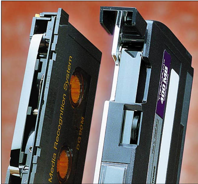
DAT-nauha on kapea verrattuna Travan-nauhoihin. Tallennustiheydessä ja -kapasiteetissa DAT on pienestä koostaan huolimatta ylivoimainen.
