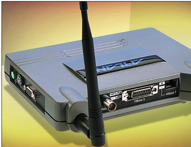
Tukiasemat kasvattavat langattoman lähiverkon kantomatkaa. Niissä on myös lähiverkkoliitäntä, jonka avulla langattomat työasemat saavat yhteyden lankaverkon palvelimeen.
