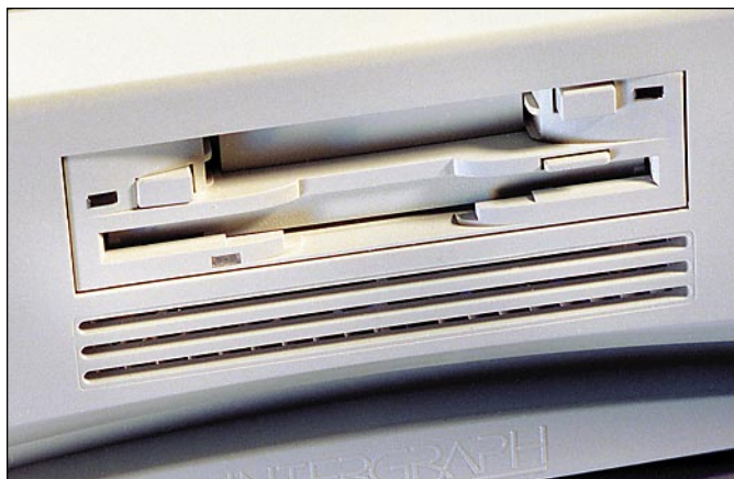
Intergraphin etulevyssä on yhdistetty levykeasema ja PC-Card-korttipaikat.
