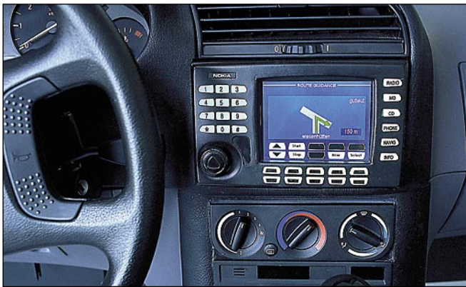
Nokian autopäätteseen on yhdistetty paikannusjärjestelmä, reittiopastus, tietopalvelut ja puhelin.
