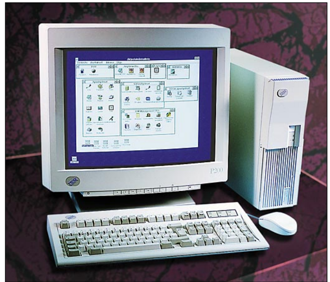
Koneen etupaneelissa on levy- ja mahdollisen CD-aseman eteen lukittava liukukansi.
