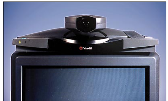
PictureTel SwiftSite on viiden kilon painoinen television liitettävä ISDN-yhteyttä käyttävä videoneuvottelujärjestelmä
