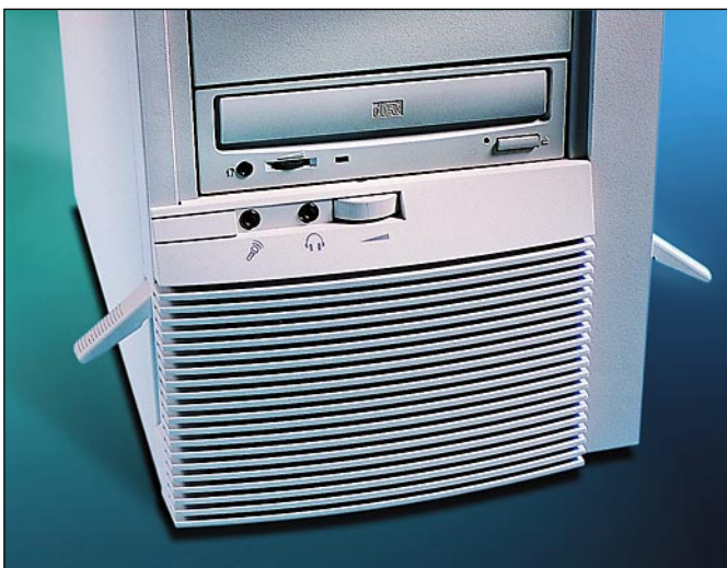
HP:n minitornikotelo ei edestä päin ole sen kummallisemman näköinen kuin tavalliset 486-mikrot. HP kiinnittää kuitenkin huomiota myös PC:n mekaaniseen rakenteeseen. Kotelon voi avata ilman työkaluja etureunan lukkosaloilla. Miellyttävä yksityiskohta on tuoda ääniliitäntä etupaneeliin.
