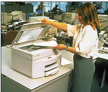
HP CopyJet on mustesuihkutekniikkaan perustuva värikopioikone, joka toimii myös mikron tulostimena.
