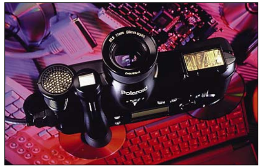
Polaroid PCD-2000 -digitaalikameran CCD-kennossa on miljoona kuva-alkiota.
