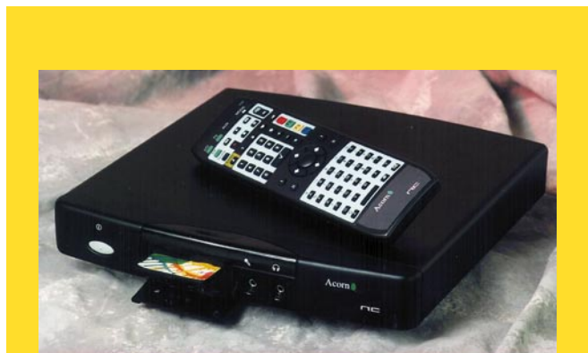
Acornin NetStation on tarkoitettu joka kodin Internet-päätteeksi. NetStationissa on sisäänrakennettu modeemi, ja sen käyttöönotto vaatii vain puhelinlinjan ja sähköjen kytkemisen, loppu sujuu itsestään. NetStationin käytön nopeuttamiseksi tärkeimmät sovellukset, tekstinkäsittely, WWW-selain ja sähköpostiohjelma on tallennettu koneen ROM-muistiin. Näytökseen se hyväksyy joko television tai super-VGA-monitorin.
