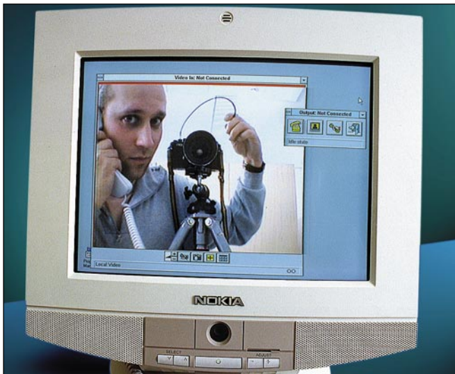
MediaStation-monitorin yläreunassa on mikrofoni ja alhaalla videokamera. Tulevaisuudessa siinä on lisäksi ISDN-liittymä, CD-asema, MPEG-purkupiiri ...
